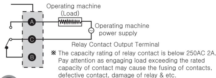
**5 Terminal Wiring Diagram**
