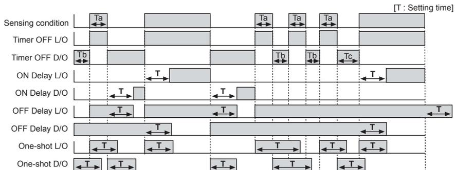
※ Setting time :  $T > T_a$ ,  $T > T_b$ ,  $T > T_c > T_b$
